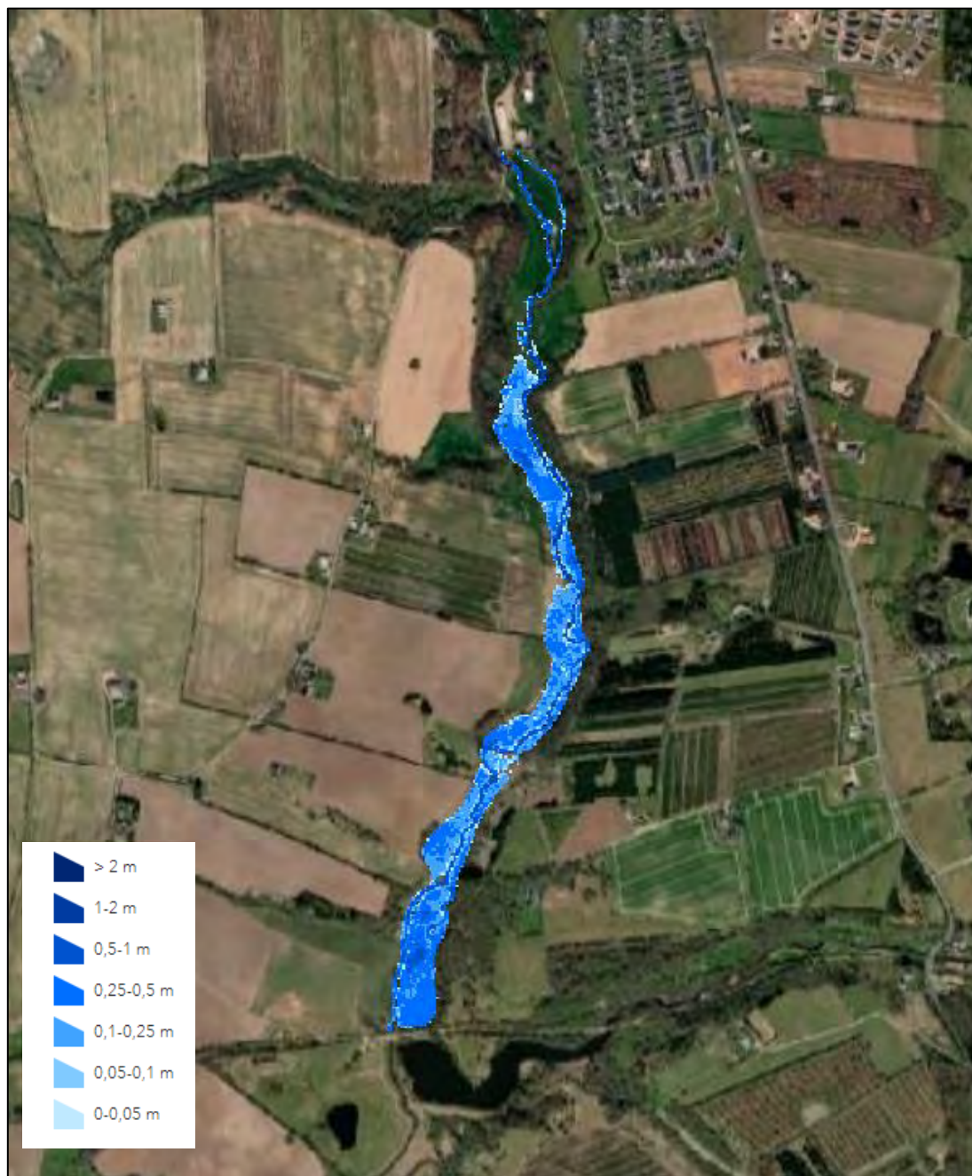
Figur 47 Området ved Troldhedestien vist med en udbredelse af oversvømmelse under de nuværende forhold, dvs. uden dæmning/sluse. Udbredelsen svarer til en gentagelsesperiode på 1 år.
