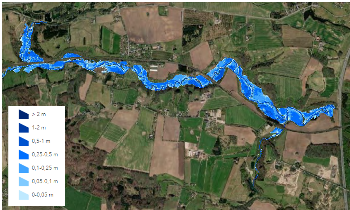
Figur 20 Området ved E45 vist med en udbredelse af oversvømmelse under de nuværende forhold, dvs. uden dæmning/sluse. Udbredelsen svarer til en gentagelsesperiode på 1 år.
