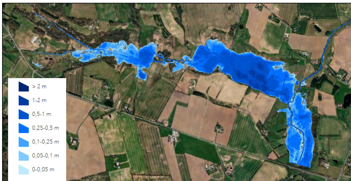
Figur 2 Området ved Bølling Bæk vist med en udbredelse af oversvømmelse under de nuværende forhold, dvs. uden dæmning/sluse. Udbredelsen svarer til en gentagelsesperiode på 1 år.
