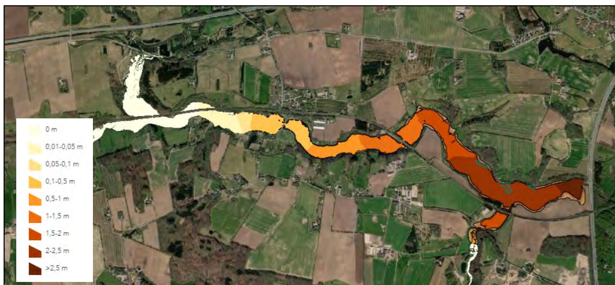
Figur 22 Vanddybdeforskel ved E45 vist ved en 100 års-hændelse i 2075 med og uden dæmning/sluse
