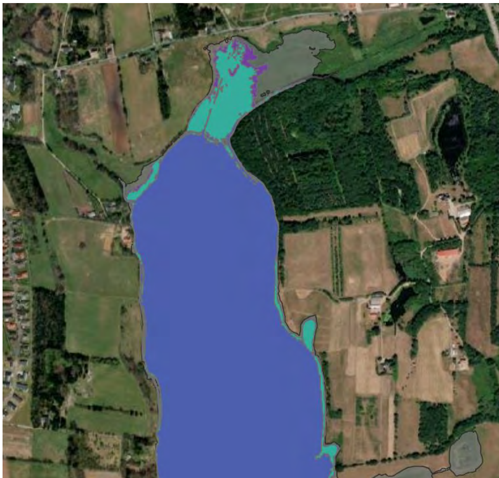
Figur 38 Varighed af oversvømmelse i et udsnit af området ved Dons ved en 100 års-hændelse i 2075 med ibrugtagen af dæmning/sluse. Også vist den maksimale udbredelse ved udnyttelse op til kote 27 m (gråt område).
